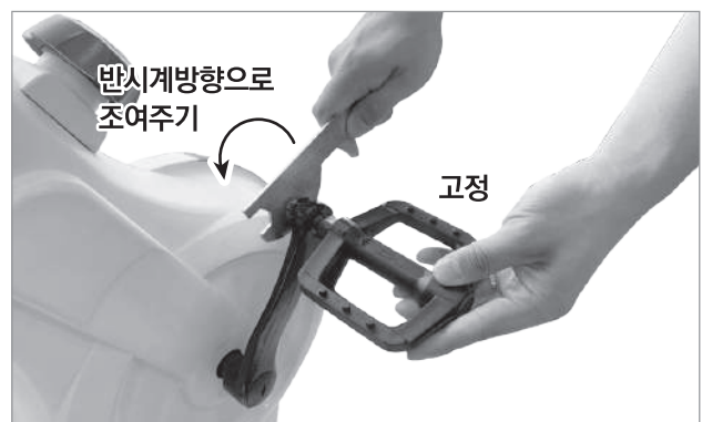
6 페달은 손으로 고정하고, 스패너를 이용해 반시계 방향으로 돌려 단단히 조여주세요.
