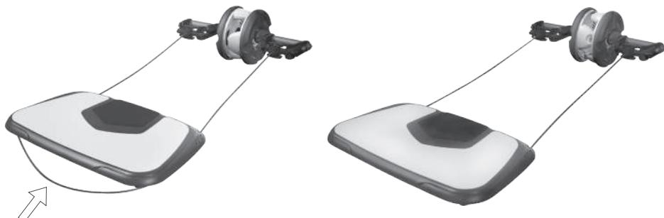
如图示，将拉力绳绕过运动板底部，并将拉力绳拉直保持平顺。
